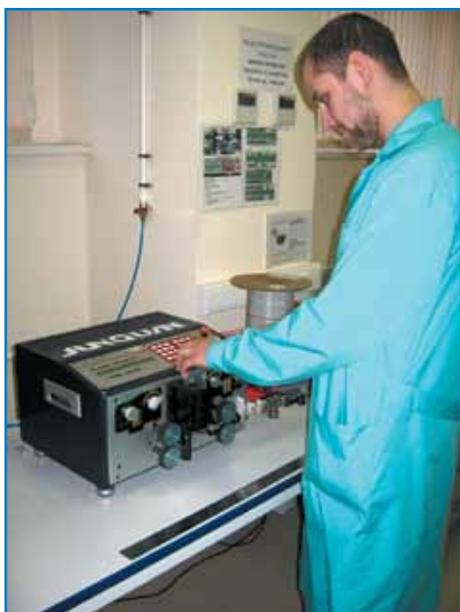
**Рис. 1.** Работа на аппарате для мерной резки и зачистки проводов
